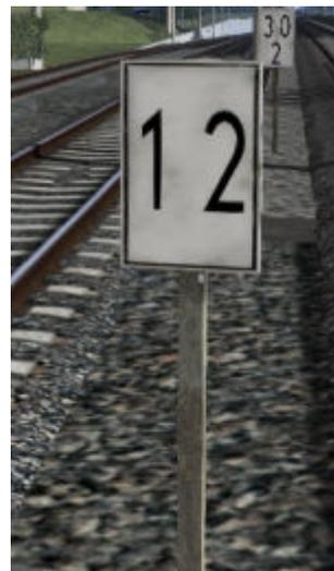
Ne 2 **„Vorsignaltafel“** Kennzeichnung des Standortes eines Vorsignals
