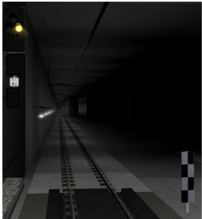
Ne 5 **„Haltetafel“** Kennzeichnung des Halteplatzes der Zugspitze bei planmäßig haltenden Zügen.
