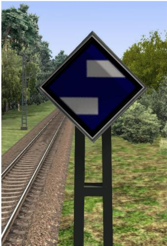
El 4 **"Bügel ab"** Bei passieren des Signals müssen alle Stromabnehmer des Zuges gesenkt sein.
